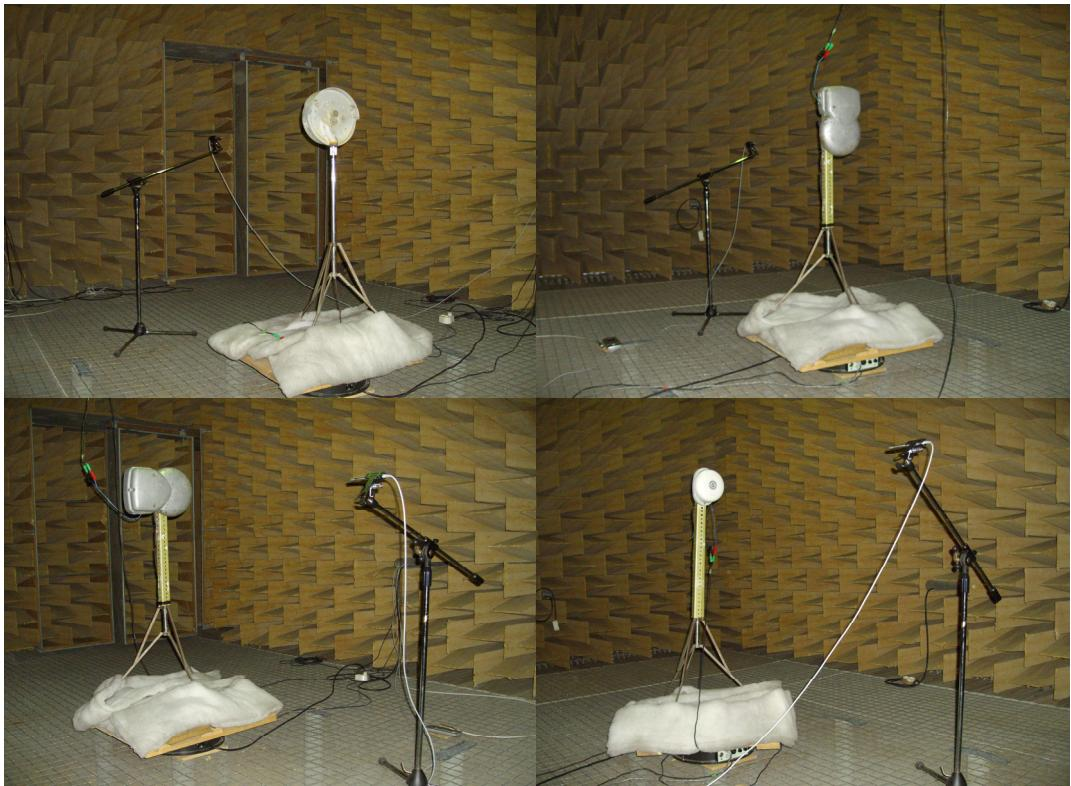
Figura 3 – Ensaios em câmara anecóica das três campainhas de passagem de nível
