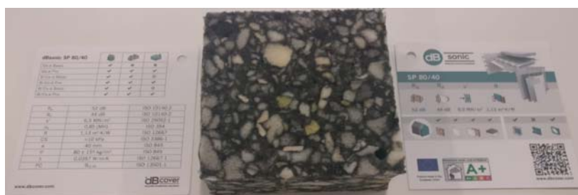
Figura 5. Muestra y características del material absorbente empleado en la maqueta
