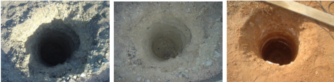
Figs.26-28 Ejemplos de perforaciones hechas en distintos tipos de terreno
