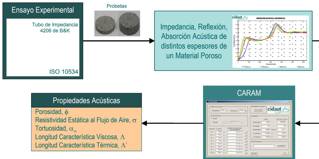
Este programa consiste en la minimización de funciones basadas en las ecuaciones del modelo acústico de fluido equivalente de Johnson-Champoux-Allard (derivadas de las Ec. de Biot) a partir de las propiedades extrínsecas acústicas obtenidas con el tubo de impedancias además de la presión y temperatura a las que se realizaron las medidas experimentales.
