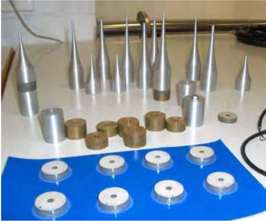
Figura 3.- Piezas diseñadas y construidas para la implementación de los 5 transductores de la Tabla 2 con sus respectivos focalizadores .
