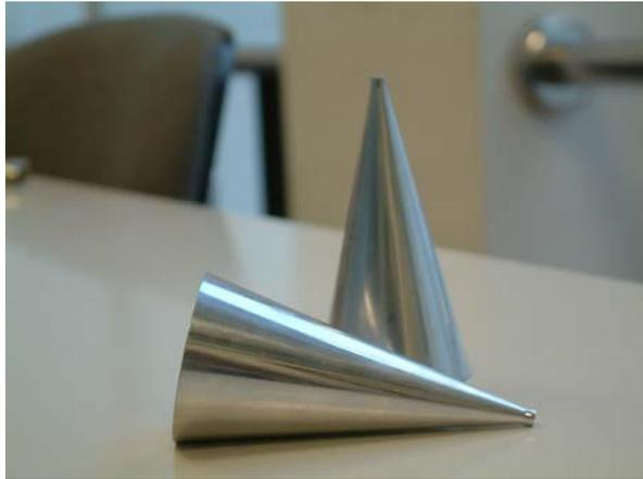
Figura 2.- Ejemplo de un focalizador de sección cónica.
