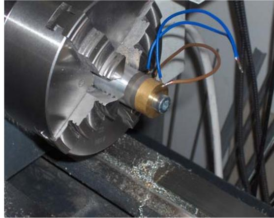
Figura 4.- Dispositivo de pretensión del transductor
