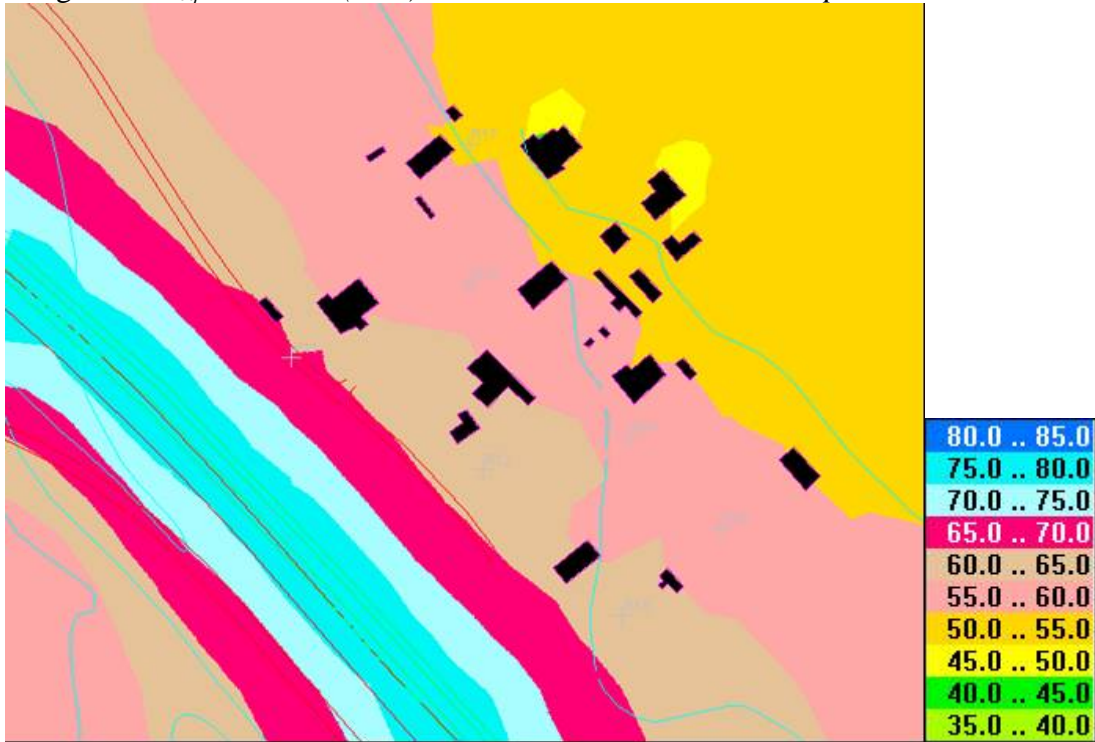
Figura 5 – L_{eq} nocturnos (dBA) Urbanización Janodembra sin pantallas acústicas
