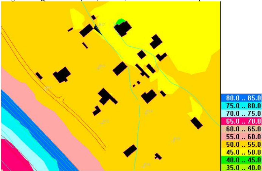
Figura 6 – L_{eq} nocturnos (dBA) Urbanización Janodembra con pantallas acústicas
