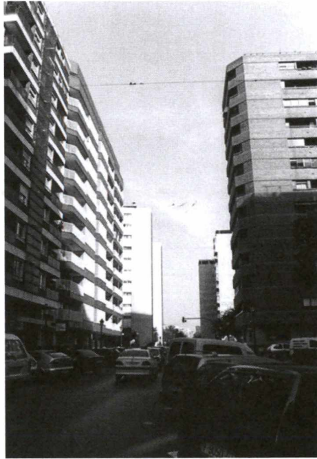
Figura 4.3. Un ejemplo de estructura urbanística inadecuada desde el punto de vista acústico (calle estrecha con edificios muy altos a ambos lados).
