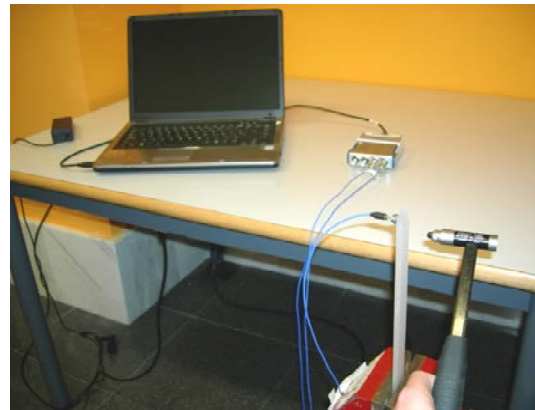
Figura 2. A) Esquema del montaje experimental: 1. Viga compuesta; 2. Tarjeta de adquisición de datos; 3. Acelerómetro; 4. Martillo calibrado; 5. Ordenador. B) Fotografía del sistema.
