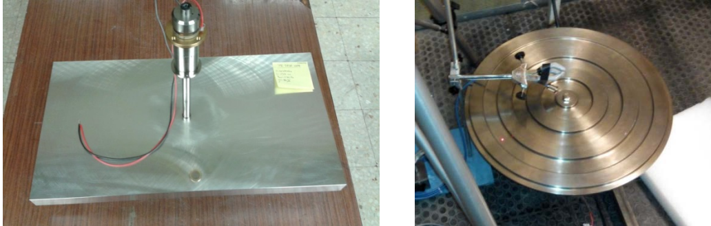
Figura 3. a) Transductor UdP con placa rectangular; b) Transductor UdP con placa circular.
