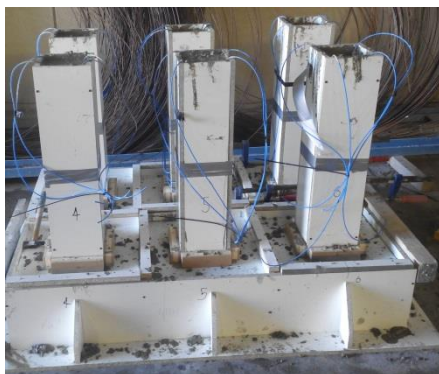
Figura 4: Pilares en el encofrado
