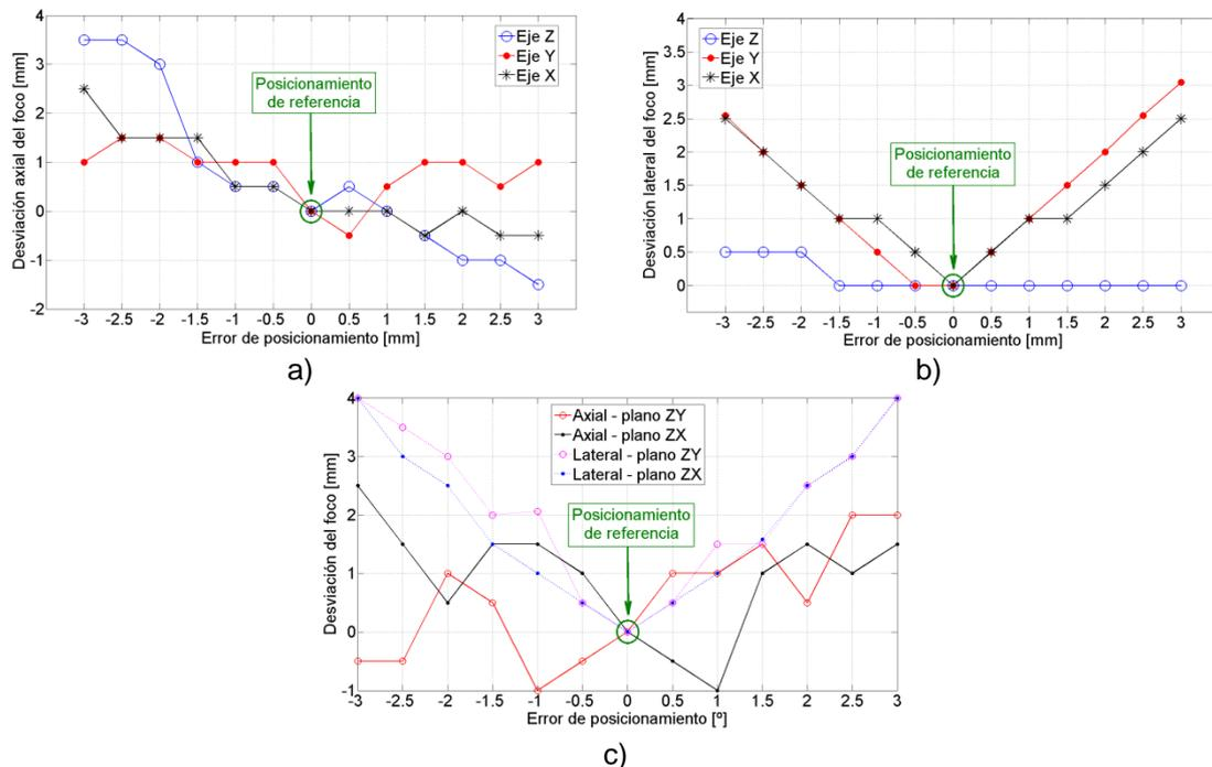
**Fig. 3.** Desviación del foco frente a error cometido del posicionamiento del transductor respecto al cráneo: a) y b), desviación axial y lateral, respectivamente, al cometer un error lineal entre -3 mm y 3 mm; c) desviación axial y lateral al cometer un error angular entre  $-3^\circ$  y  $3^\circ$ .
