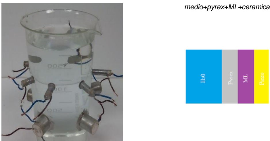
Figura 6. A la izquierda, imagen de todas las cerámicas con ML pegadas a la pared de una vasija de cristal pyrex. A la derecha, esquema de la transmisión acústica.
