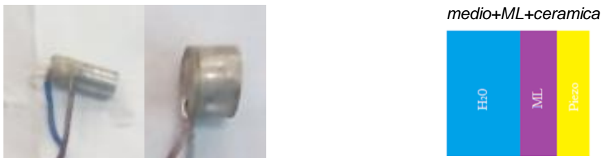
Figura 5. A la izquierda, imagen de dos de las cerámicas utilizadas pegadas a un ML. A la derecha, esquema de la transmisión acústica.
