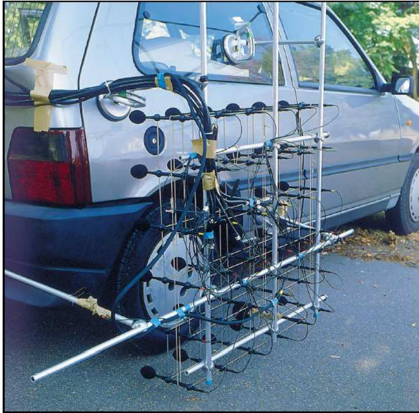
Figura 14: Posicionamento de microfones para medição do ruído do pneu durante o movimento do veículo. [7]
