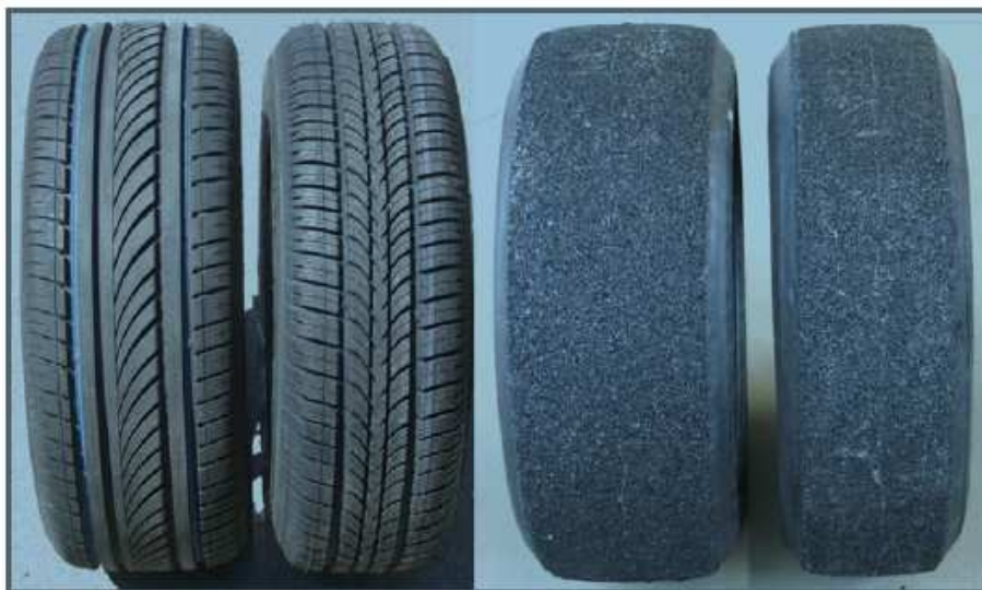
Figura 29- Dois protótipos de pneus porosos (esquerda) em comparação com pneus normais (direita) [14]
