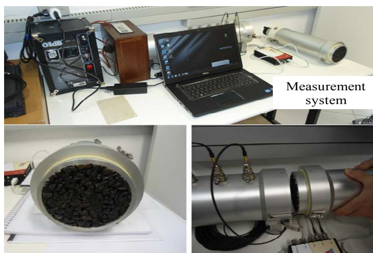
Figura 22- Sistema de medição de coeficiente de absorção sonora da UFSC - Brasil
