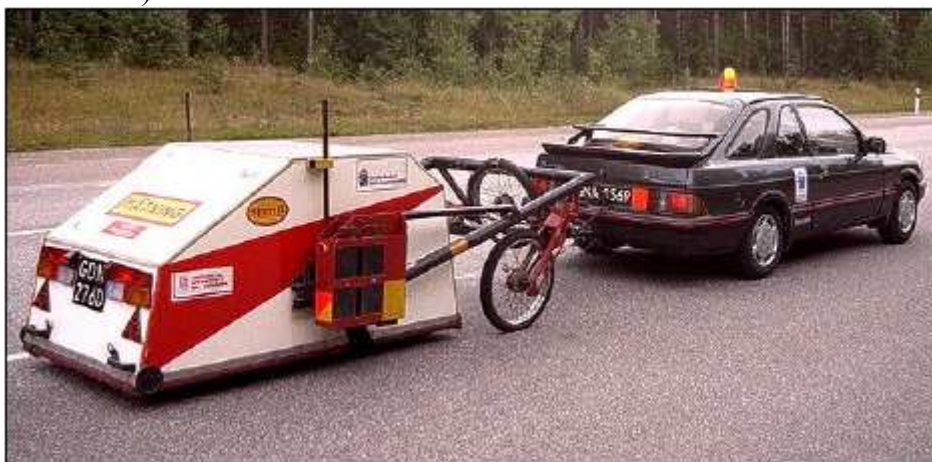
Figura 11A: Ensaio de ruído usando o método Trailer . [9]
