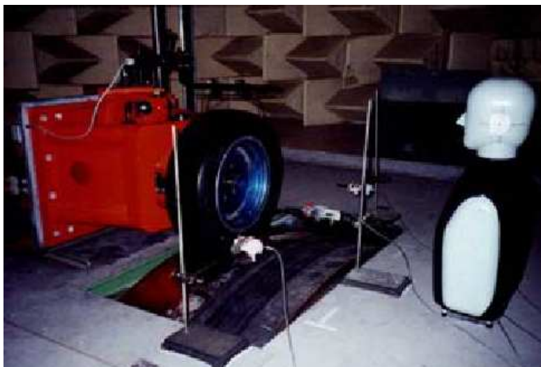
Figura 19: Gravação binaural do ruído dos pneus usando torso. [3]
