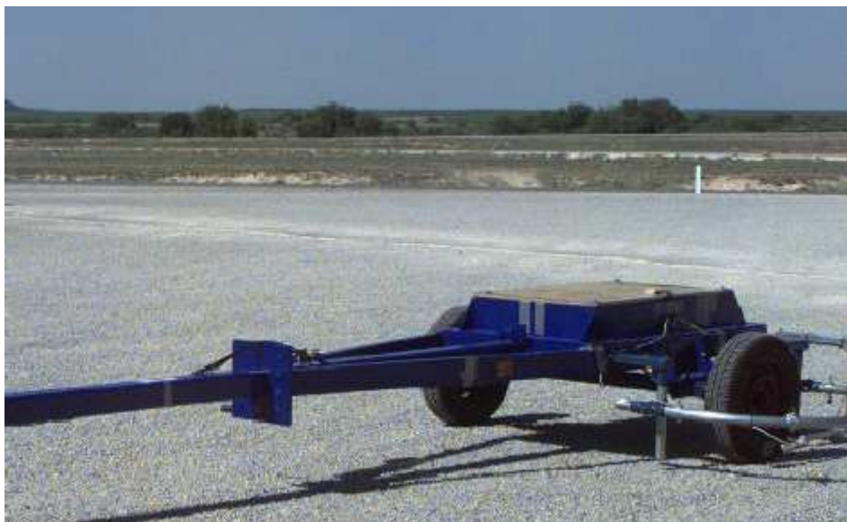
Figura 13: Exemplo de Trailer utilizado no método híbrido (coast-by com trailer).
