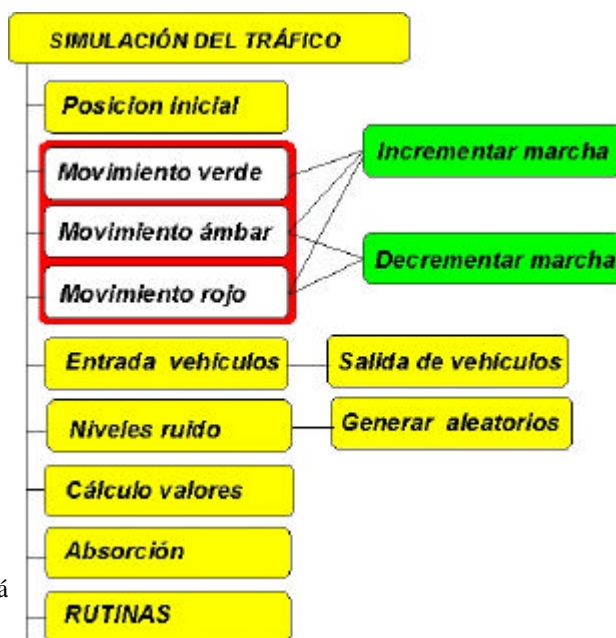
fig. 4 Esquema básico que muestra el proceso de simulación del tráfico en el tramo de vía considerado.
