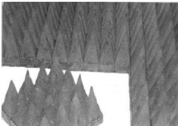
Figura 6. Material absorbente de microondas desarrollado para el recubrimiento de las paredes internas de la jaula de Faraday.
