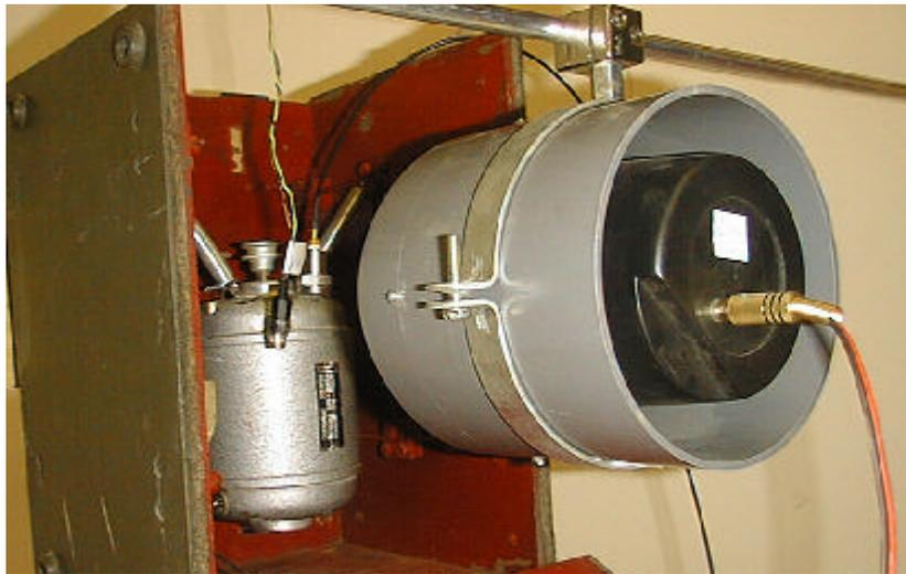
Fig. 1: Planta experimental para la descarga acústica. Obsérvese la fuente secundaria orientada hacia el motor eléctrico.
