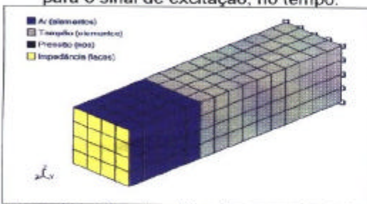
Figura 5 – Canal auditivo humano simulado, com o protetor tipo tampão.
