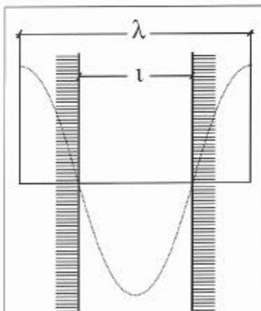
Figura 1.- Relación entre la longitud de la onda de la primera frecuencia estacionaria y la dimensión existente entre los dos paramentos paralelos y reflejantes que la forman.
