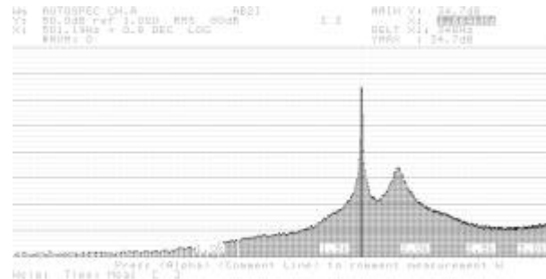
Fig. 12. Espectro de frecuencia alrededor del tono fundamental, Condición C2, semi-tubo izquierdo
