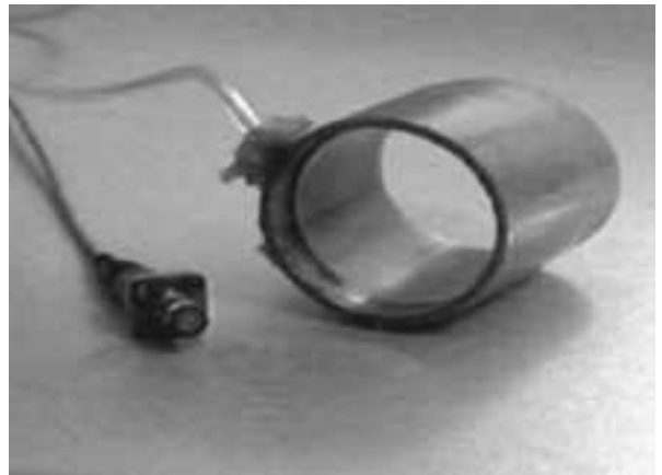
Fotografía de dos hidrófonos de fibra óptica. Arrollamiento y membrana
