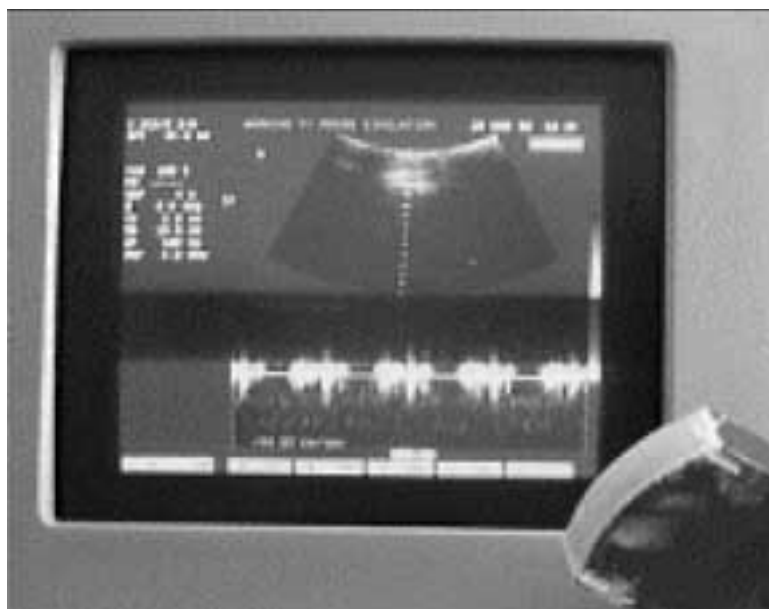
Imagen ecográfica obtenida con el array que se aprecia en la fotografía. 5 MHz, 148 elementos.
