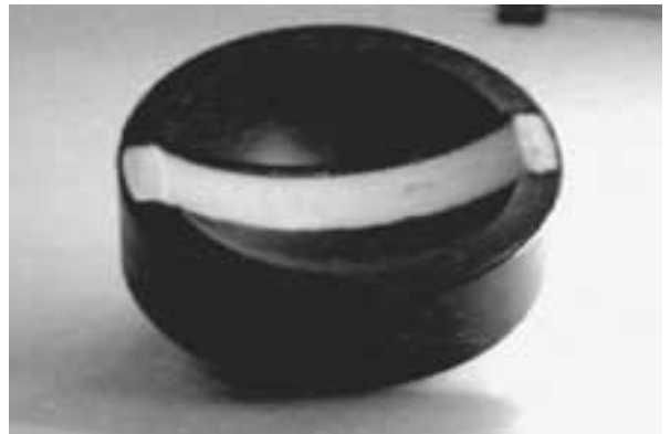
Fotografía de un array cóncavo de 3.5 MHz y 96 elementos. Aplicación: ecocardiografía tridimensional.
