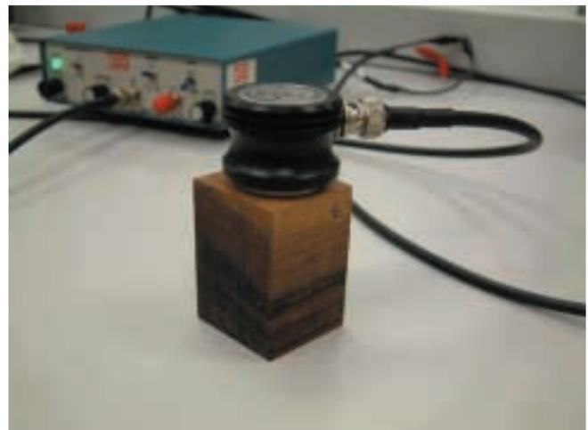
Figura 2: Configura de medida del método eco-impulso
