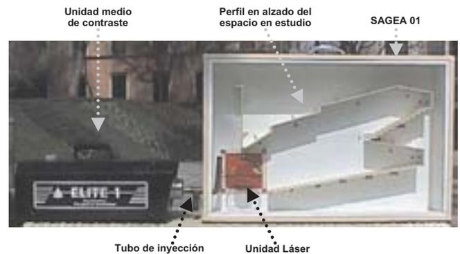
Figura 01. Partes esenciales del SAGEA 01. Foto del autor.
