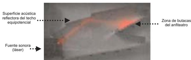
Figura 06. Trayectoria de la onda sonora (láser). Foto del autor.
