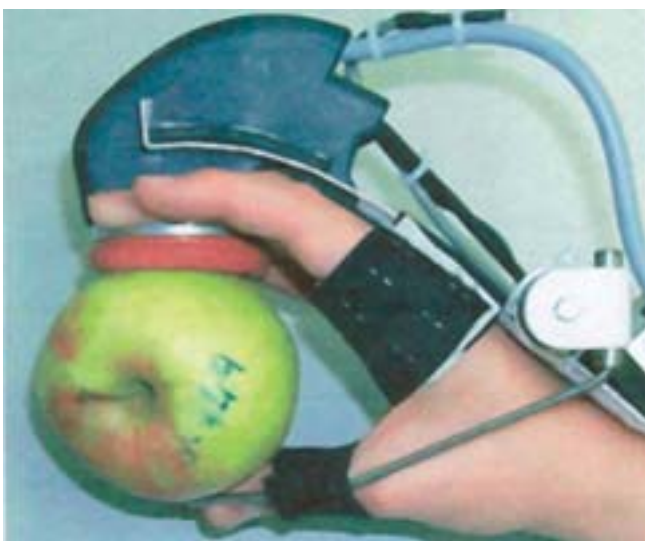
Figura 4: Dispositivo portátil para ensayo de respuesta acústica al impacto en fruta en árbol (De Belie et al. 2000)
