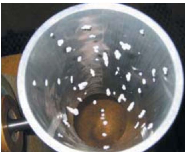
Figura 3. Disposición del lecho fluido en el interior del cilindro cuando se aplica potencia al transductor.
