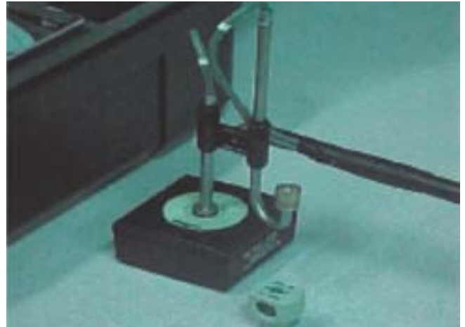
Figura 5 – Primeira configuração com o acoplador para calibração do segundo microfone.
