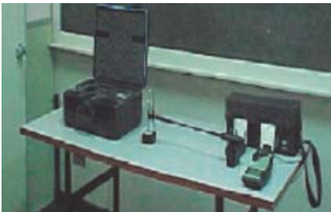
Figura 4 – Configuração para calibração do primeiro microfone.
