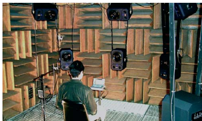
Figura 17. Sistema de simulación del campo acústico con ocho canales, en cámara anecoica.
