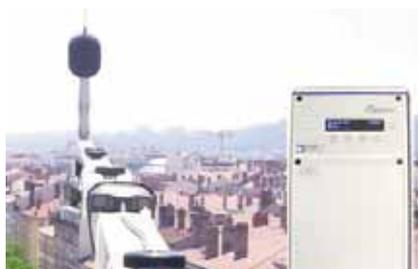
El monitor Oper@EX está específicamente diseñado para trabajar en intemperie, en cualquier ambiente, gracias a su IP55 y cuenta con una precisión Tipo I conforme a la IEC 61672 que le permitirá realizar medidas de ruido ambiental, cumpliendo con los requisitos de instrumentación exigidos la normativa vigente como el R.D. 1513/2005 y el R.D. 1367/2007.
