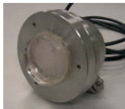
Figura 2. Transductor emisor con la lente focalizadora adherida.
