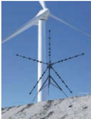
Se trata de un array pentagonal de 30 micrófonos de bajo coste (modelo 4949) con un diámetro de 3,5 metros.
