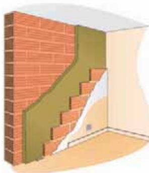
Aplicación del Acustilaine E en Tabique cerámico.
