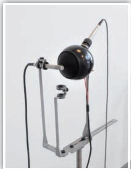
El sistema permite la calibración y test de todas las sondas comerciales de Microflown Technologies en todo el rango audible. Además de la comprobación del estado de la sonda es posible la aplicación de diferentes métodos de ajuste, con el objetivo de reducir el rango de incertidumbre de su medida en un rango frecuencial específico.
