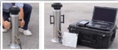
El sistema ACUPAVE, consiste en un tubo de impedancias portable para la realización de medidas in situ conforme a las normas ISO 13472-2 e ISO 10844 para la absorción de pavimentos, e ISO 10534-2 y ASTM E-1050 para la absorción de materiales en general. Así, algunas de sus aplicaciones principales son:
