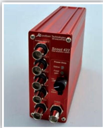
Desarrollado para aplicaciones acústicas y vibroacústicas, basadas en las sondas PU de Microflown y optimizado para nuestros softwares como Scan & Paint, Intensity y Impedance. Además, el frontend puede ser utilizado con otros sensores como micrófonos, acelerómetros, sensores IEPE o tacómetros.
