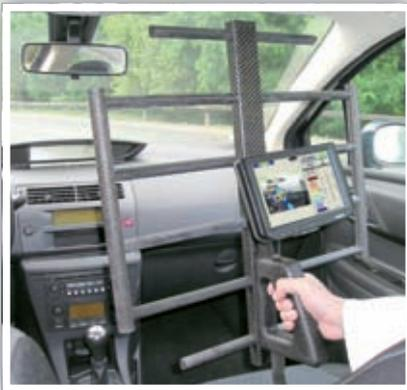
El array rectangular de fibra de carbono de 32 micrófonos del que dispone la cámara acústica ACVS200 garantiza una gran resolución y rango dinámico. El sistema dispone de un sistema de adquisición de datos modulable en número de canales para integrar medidas con otras antenas o con sensores externos. Las dimensiones de la antena no exceden los 55 centímetros de largo x 55 centímetros de ancho. Su tamaño lo convierte en un equipo manejable, ligero y de fácil manejo.
