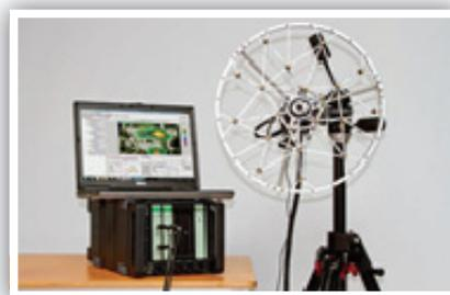
Mediante este equipo se pueden localizar fuentes de ruido de media-alta frecuencia tanto en tiempo real como en post-procesado.
