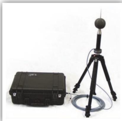
La maleta resistente contiene el sonómetro y una batería recargable permitiendo que el instrumento funcione continuamente hasta
