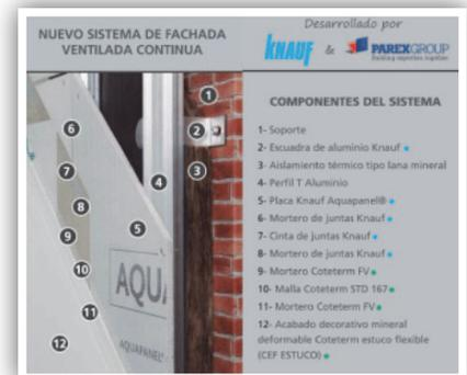
El sistema se compone de una estructura portante de aluminio y placas de exterior de cemento Portland con aditivos aligerantes no orgánicos y reforzados con malla de fibra de vidrio, que se revisten con un mortero base armado con malla y se finalizan con acabados decorativos minerales continuos y deformables.
