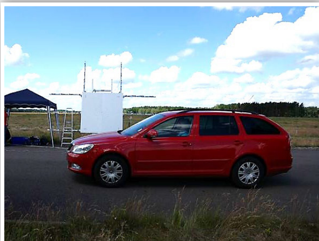
Figura 3. Localización de fuentes de ruido durante el pass-by.
