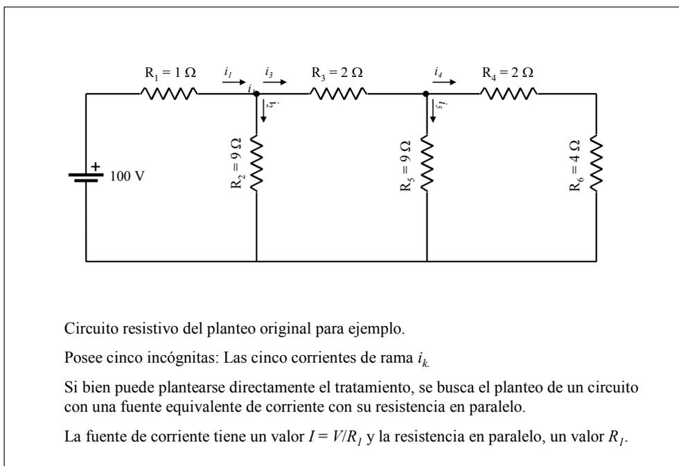
Figura 1. Circuito eléctrico resistivo al que se aplica el método de cálculo
