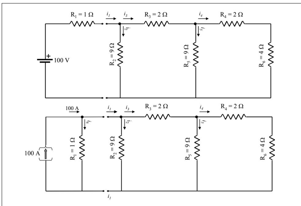
Figura 2. Fuente de tensión y de corriente equivalentes.
