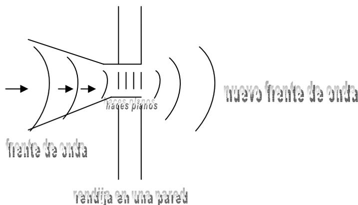
**Figura 2.** Fenomeno de difracción dentro del difusor (ej. En una rendija de una pared)
