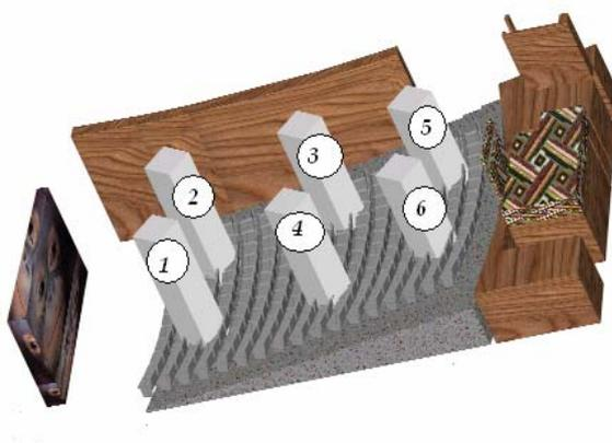
**Figura 6.** Ubicación del micrófono de medición (postes en medio de la sillería)
