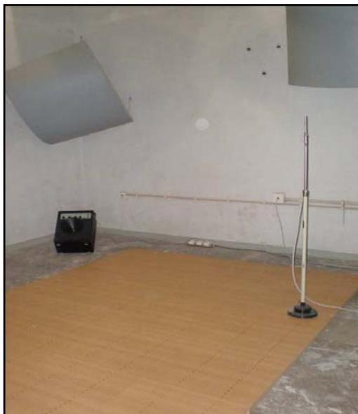
**Figura 1.** Câmara reverberante do LEA do LNEC.
