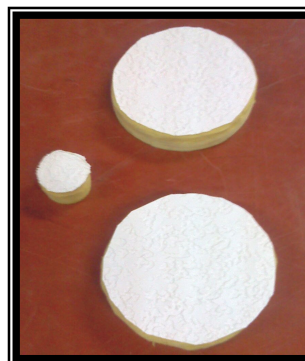
Fotografía 5. Lana de vidrio de 20 mm con lámina de PVC
