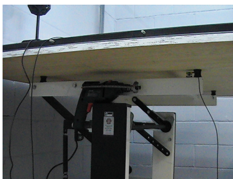
Figura 5. Acoplamento da fonte de vibração (furadeira) na estrutura de apoio.
