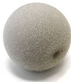
Figura 3. Windscreen utilizado nos testes, 5,0 cm de diâmetro
