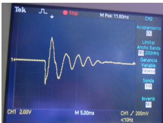
Figura 2. Respuesta Micrófono Piezoeléctrico
