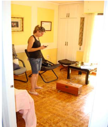
Figura 5: Máquina de impactos funcionando directamente sobre el suelo.
