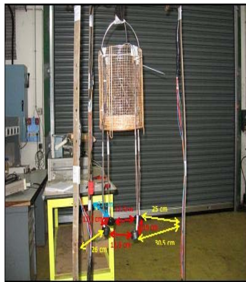
Fig3. Detalle del tanque hiperbárico. Fig4. Detalle de la geometría del montaje experimental.
