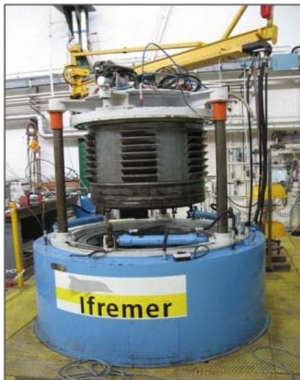
Fig3. Detalle del tanque hiperbárico. Fig4. Detalle de la geometría del montaje experimental.
