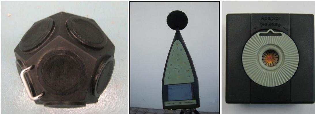
**Figura 2. Fuente de ruido omnidireccional B&K4296 (izquierda), sonómetro B&K 2260 Investigator (centro), y calibrador B&K 4231 (derecha) (no escalados)**
