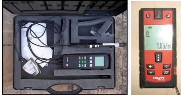
**Figura 1. Equipo TESTO 400 multifunción para medición de datos atmosféricos (izquierda). Medidor de distancias láser Hilti PD-40 (derecha) (no escalado)**
