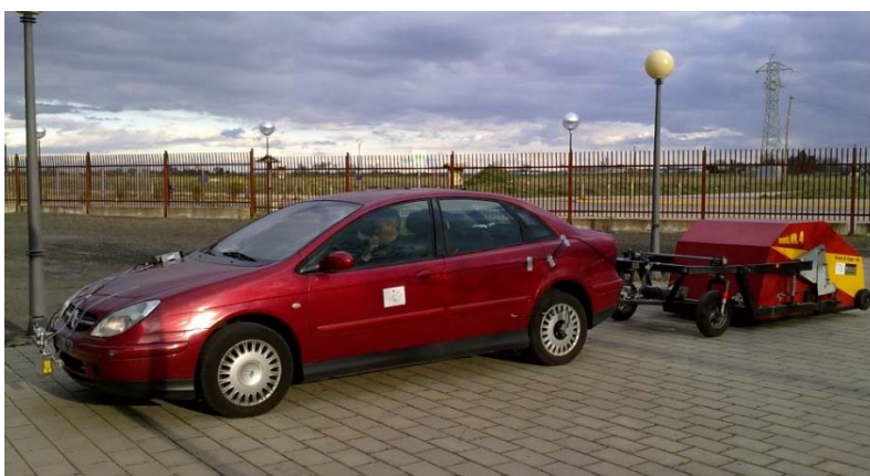
Fig.1.- Equipos empleados en la auscultación acústica
