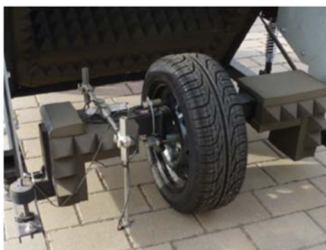
Fig.2.- Equipo Tiresonic Mk4-LA 2 IC. Disposición de micrófonos.
