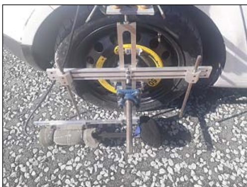
Figura 4. Configuración del sistema OBSI utilizado.
