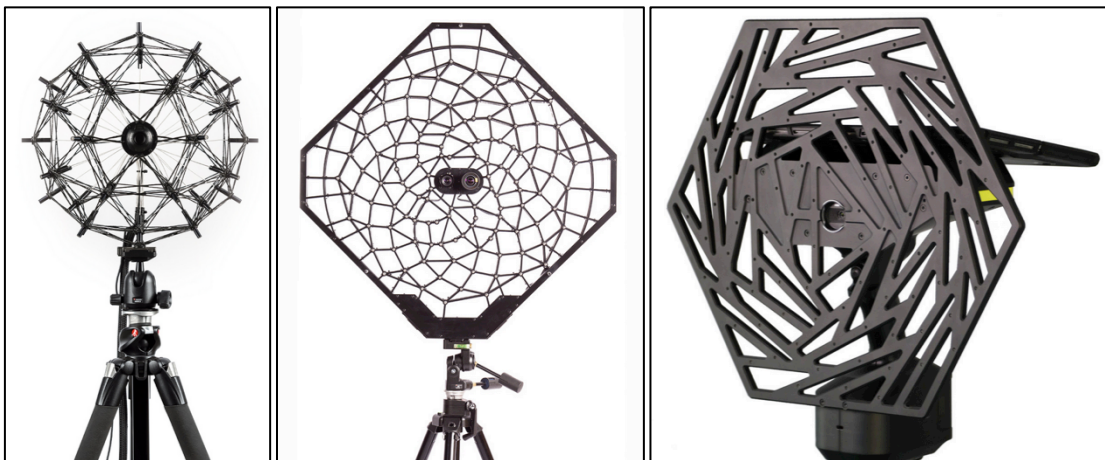
Figura 4.- De izquierda a derecha, arrays de micrófonos esférico para beamforming, array de micrófonos plano para holografía y sistema portátil
