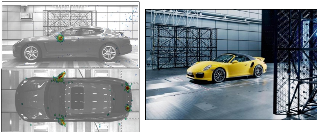
Figura 6.- Localización de fuentes de ruido en túnel de viento [2]
