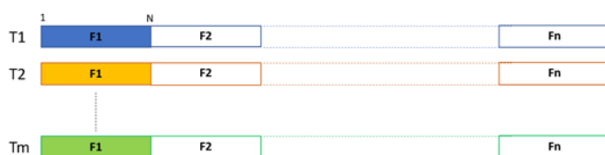
Figura 1. División de las pistas de audio ( T ) en fragmentos ( F ) de tantas muestras como la longitud del buffer ( N ). La longitud de las pistas es L .
