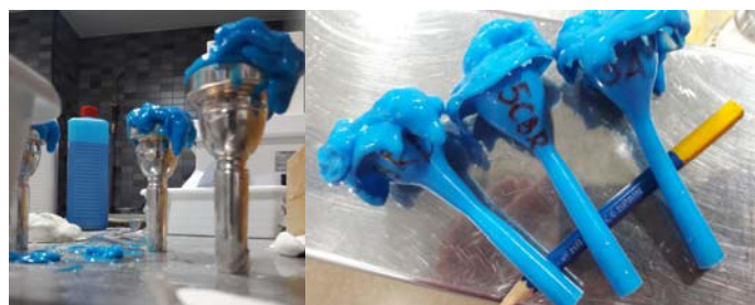
Figura 1. Moldes de silicona para la obtención de medidas internas de las boquillas.
